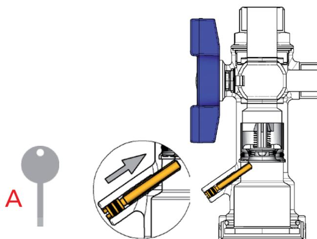
Valvola a sfera integrata nel gruppo di circolazione per il sezionamento dei collettori solari dall'impianto, è dotata di valvola di non ritorno per impedire circolazioni indesiderate. Qualora, in particolari condizioni di funzionamento (per esempio durante la fase di caricamento dell'impianto), fosse necessario far circolare il fluido termovettore anche nel senso opposto a quello ordinario, è possibile aprire la valvola di non ritorno utilizzando l'apposita chiave **A** per manovrare le aste.
